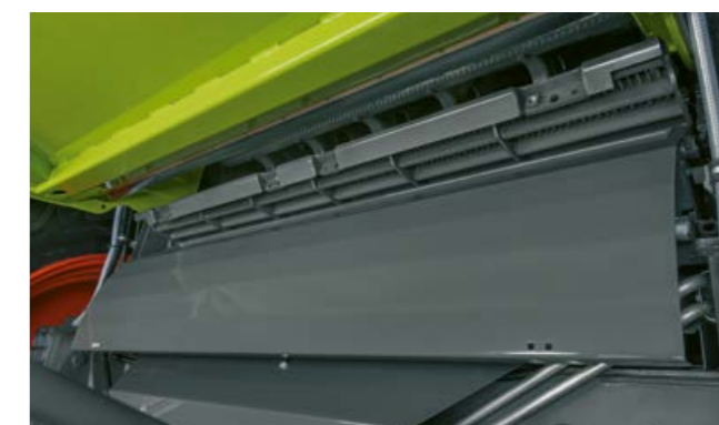
Segment klepiska można łatwo wyciągnąć przez chwytacz kamieni.
