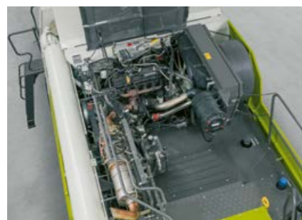
Silnik Cummins z obróbką spalin AdBlue (Stage V).
